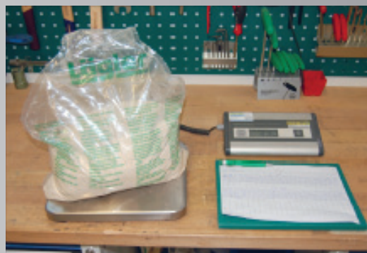
Obr. 3 Vážení odbroušeného dřevěného prachu na decimální váze
