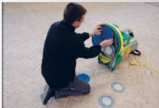
Obr. 2 Výměna brusiva na brusce TRIO
